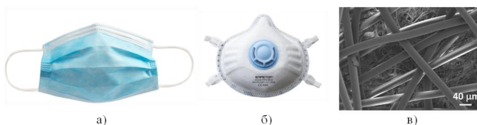
Слика 2: Маски што најчесто се користат: а) медицинска маска, б) респиратор FFP2 и в) SEM 2 -микрографија на која се гледаат надворешниот и внатрешниот слој (со многу рафинирана структура во форма на мрежа од влакна со дијаметар помал од 1 μm) на FFP2-маска.
