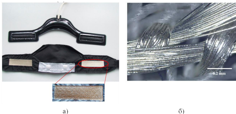
Слика 4: а) Слика на ЕКГ-појасот со детаљ од везаните електроди, б) Зголемен приказ на електродата изработена од полимерно влакно обложено со Ag/Ti (преземено од реф. [48] – издание со (CC)-лиценца)
